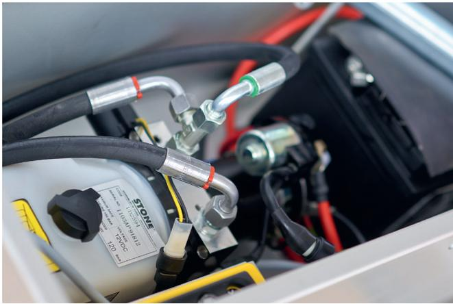
1 Deichselbox mit Batterie und Pumpenaggregat
